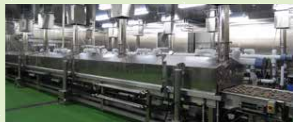
新導入設備：上／ダブルベルトグリル焼成、下／マルチスチーマー
