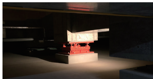
新開発センター 床下の微振動対策ダンパー
