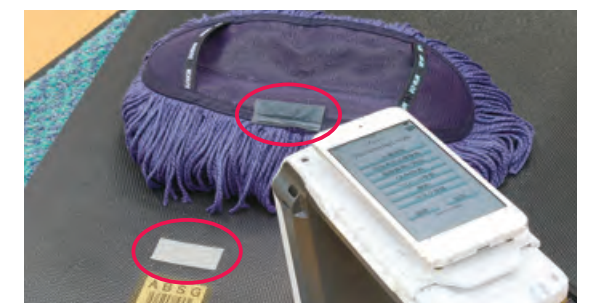
モップやマットに取り付けられたRFIDタグ（赤丸で囲った部分）。ハンディタイプの読み取り機は主に加盟店での検品や棚卸しに活用される
