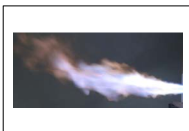
水素 60%/天然ガス 40%
