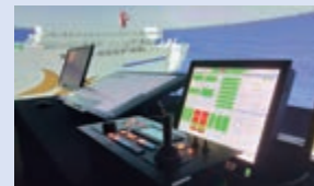
実証試験に向けた自律操船システムのシミュレータによる検証
