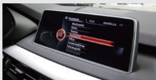
偏光板を使う液晶ディスプレイによるクラスターパネル
