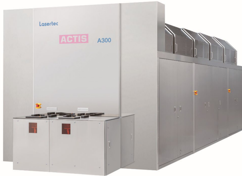
アクティニック EUV パターンマスク欠陥検査装置 ACTIS 「A300」シリーズ
