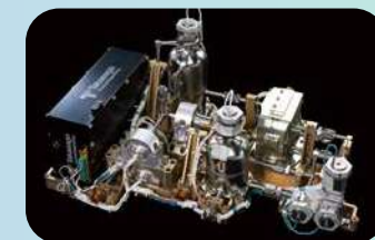
月着陸船に搭載した月面用水電解装置
